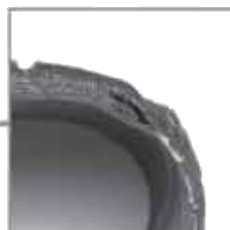
Hombro separado. - Un surco gastado en el hombro de la llanta generalmente es evidencia de desprendimiento.
