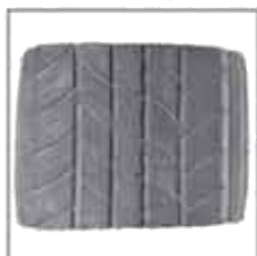
Hombro separado. - Un surco gastado en el hombro de la llanta generalmente es evidencia de desprendimiento.
